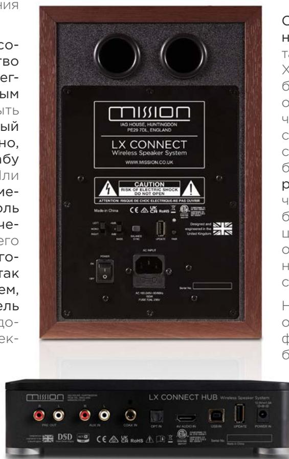
Две активных колонки LX Connect могут быть размещены на расстоянии до 20 м от хаба, там где пожелает пользователь. Хаб передает им данные по беспроводной сети на частотах от 5,2 ГГц до 5,8 ГГц, автоматически переключаясь для обеспечения наиболее стабильного соединения. Можно передавать без проводов аудио высокого разрешения до 32 бит/192 кГц – что выглядит впечатляюще для беспроводных колонок любого ценового уровня – с полностью оптимизированным согласованием по времени для идеального стерео.
